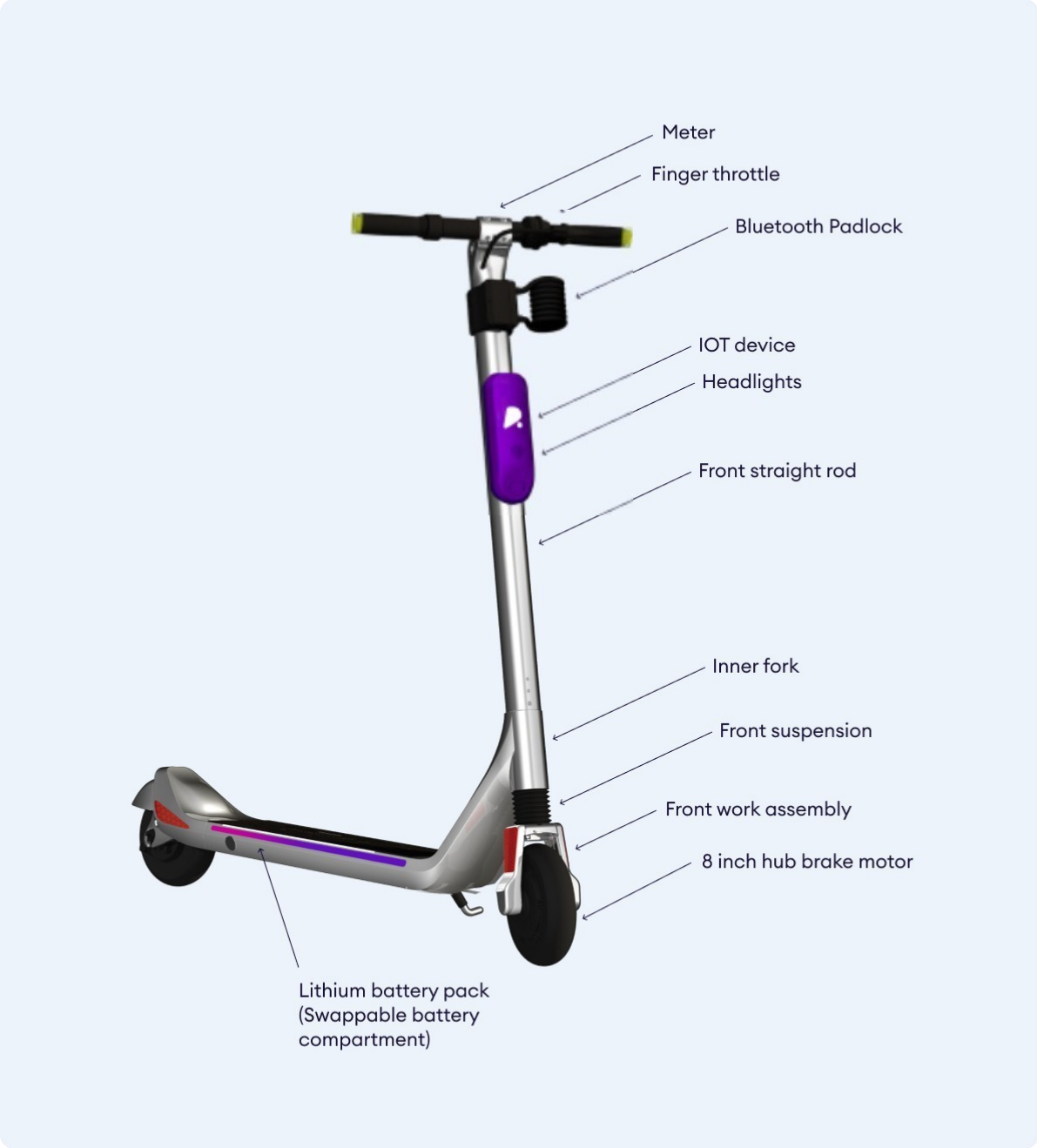
3.1 Figura 1: Schema del veicolo completo
